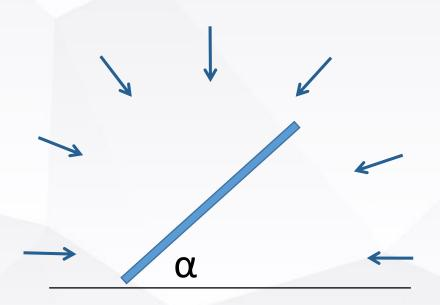
α/180° 这部分的散射辐射 被遮挡无法到达组件表面
